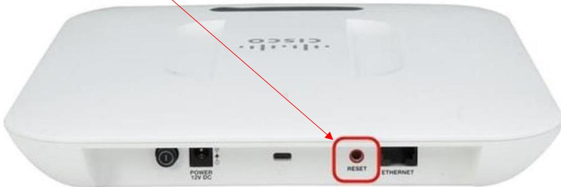
L'accès au point Wi-Fi redémarrera pendant environ une minute avant de se réinitialiser avec sa configuration par défaut.
